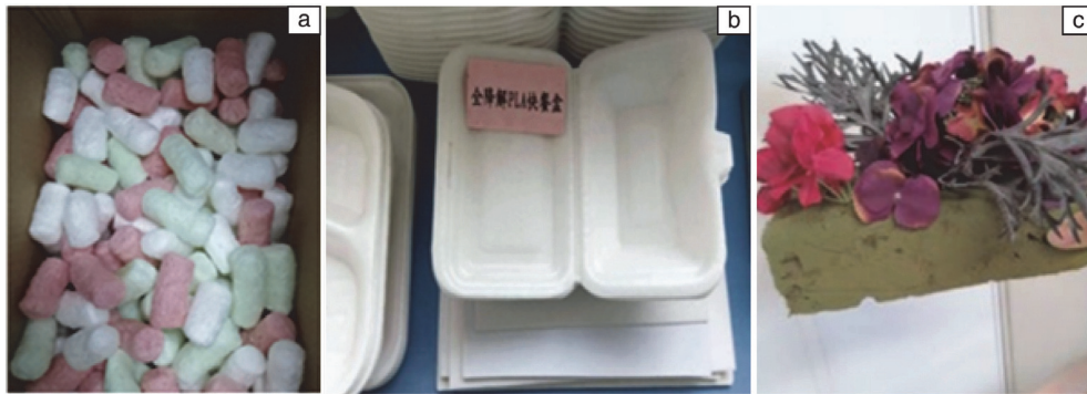
图 8 淀粉基发泡缓冲塑料(a), PLA 发泡餐盒(b), PLA 花卉底座(c)
